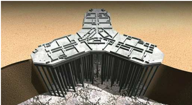
Dubai: 7432 mq è l'area della piastra difondazioni del Burj Khalifa, uno dei più alti grattacieli del mondo (828 m). Le sue fondazioni sono costituite da 192 pali trivellati del diametro di circa 1.500 mm e di 50 m di lunghezza
